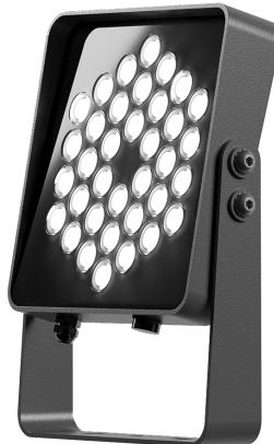
Архитектурный светильник в литом алюминиевом корпусе. Питание 220V. Всепогодную защиту IP67 обеспечивает закаленное 4мм стекло с силиконовыми уплотнителями. Светодиоды NICHIA (Япония) гарантируют стабильность спектральных характеристик. Драйвер выполненный по технологии DOB на высокоресурсных электронных компонентах обладает коэффициентом мощности >0,98, сверхмалым пусковым током, защищенный от высоковольтных импульсов. Гарантированный пуск при температурах до -50°C.
