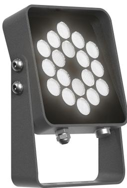
Архитектурный светильник в литом алюминиевом корпусе. Питание 220V. Всепогодную защиту IP67 обеспечивает закаленное 4мм стекло с силиконовыми уплотнителями. Светодиоды NICHIA (Япония) гарантируют стабильность спектральных характеристик. Драйвер выполненный по технологии DOB на высокоресурсных электронных компонентах обладает коэффициентом мощности >0,98, сверхмалым пусковым током, защищенный от высоковольтных импульсов. Гарантированный пуск при температурах до -50°C.
