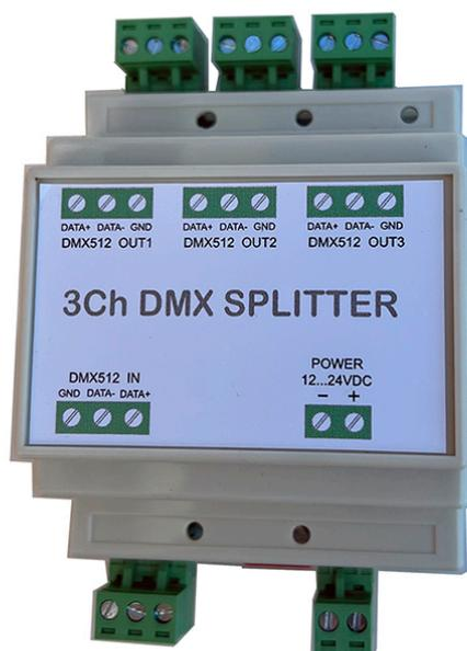
**Клеммы снимаются для удобства подключения кабеля.**
